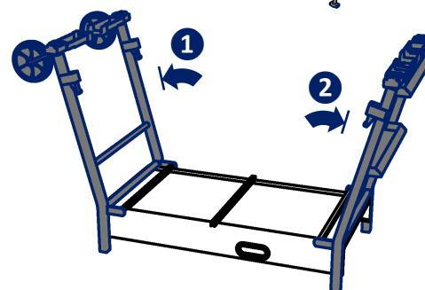
**2** Aprire le gambe di supporto **1** poi quelle di salita **2**, fino al finecorsa.
