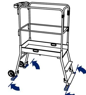
**6** Ruotare gli stabilizzatori fino a finecorsa, a seconda dell'ambiente, vedere il capitolo sulla stabilità della piattaforma mobile.
