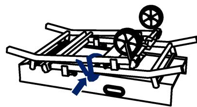
**1** Posizionare la tavola completa a terra e staccare la cinghia di mantenimento dalle gambe.
