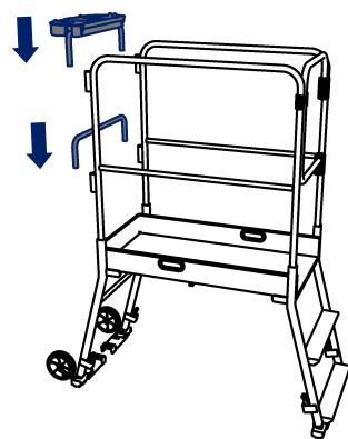
**5** Assemblare il ripiano e la barra di protezione sul parapetto. Questi 2 elementi possono essere invertiti in base alle esigenze.
