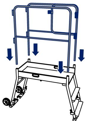
**4** Inserire il parapetto nei montanti delle gambe. Il parapetto con cancelletto va posizionato a destra.
